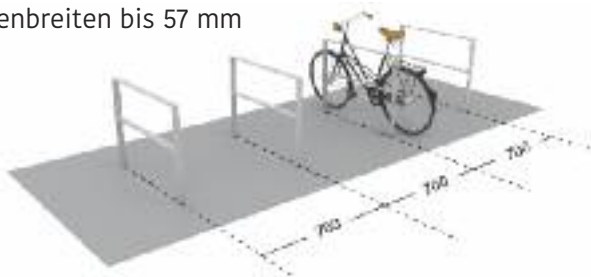
Mindestbreite pro Fahrrad bei Tiefeinstellung: 700 mm
